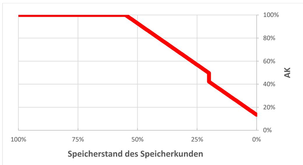
Die verfügbaren **Ausspeicherkapazitäten** des **Speicherkunden** (AK) werden unterhalb eines **Speicherstandes** des **Arbeitsgasvolumens** (AGV) von 55,0348189415042 % wie folgt berechnet:
