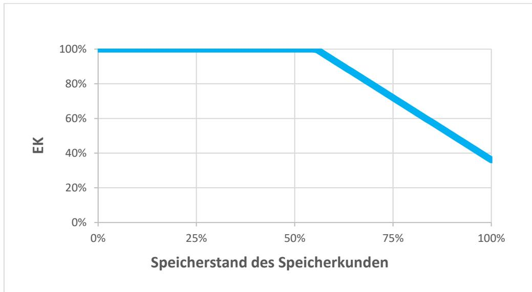
Die verfügbaren **Einspeicherkapazitäten** des **Speicherkunden** (EK) werden oberhalb eines **Speicherstandes** des **Arbeitsgasvolumens** (AGV) von 55,7827298050139 % wie folgt berechnet:
